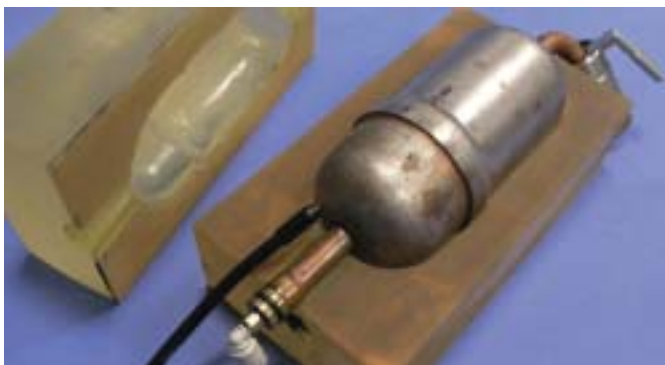
クロスリークチェックの後に、リーク箇所をさがす様子
