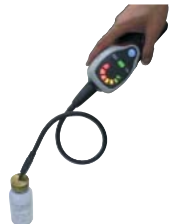
スニファ用校正器は現場での迅速な校正作業に最適です。
