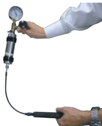
スニファ用校正器は現場での迅速な校正作業に最適です。
