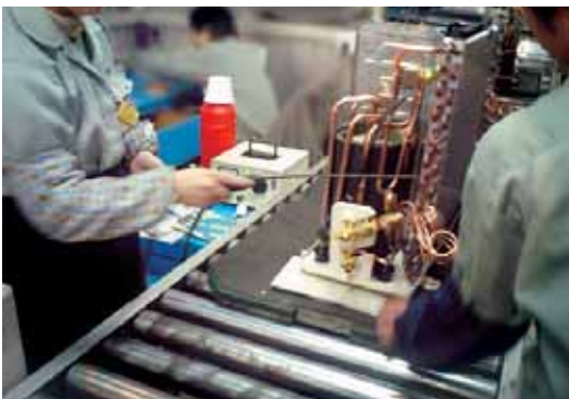
エアコン室外機生産ラインでの漏れ検査
