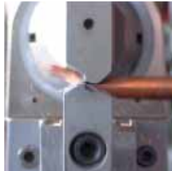
ソノロード(上)とアンビル(下)で挟み込むと同時に超音波で瞬間溶接
